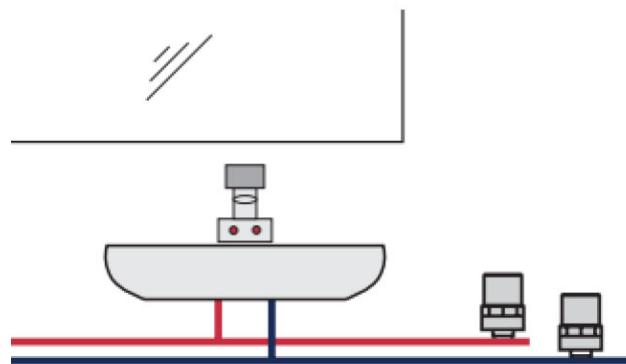
2. При коллекторной разводке трубопровода рекомендуется устанавливать компенсатор гидроудара на коллекторе.
